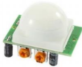
Figura 11: Sensor de presença PIR
